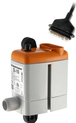
Grâce à son débit important, la pompe monobloc Si-10 convient à tout climatiseur jusqu'à 20 kW. Intégrant une technologie de piston spécifiquement conçue pour le relevage des condensats produits par les climatiseurs, la Si-10 est d'une grande fiabilité, dans tout type d'environnement. Silencieuse, elle n'émet jamais plus de 23dBA, quel que soit le volume de condensats à évacuer.
